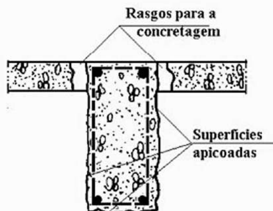
Figura 3.54 - Preparação da viga para reforço ao cisalhamento
