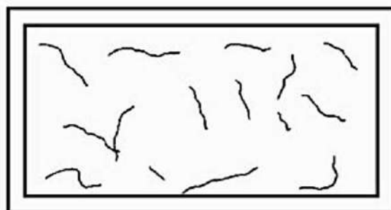
Figura 1.41 - Fissuras de retração em lajes
