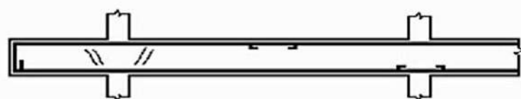
Figura 1.27 - Fissuração por cisalhamento, por insuficiência de armaduras para combate ao cortante
