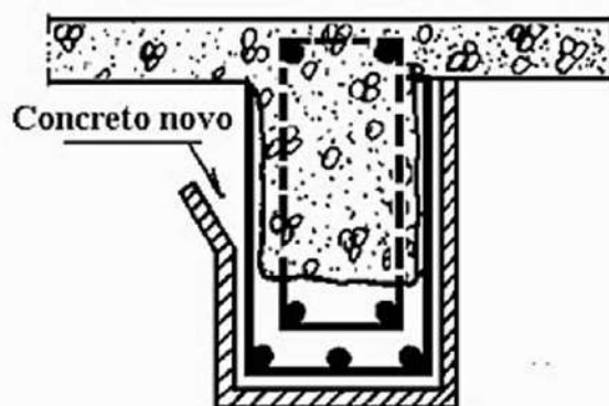
Figura 3.52 - Reforço de vigas com aumento da seção de concreto - colocação das fôrmas
