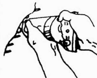
Figura 3.13 - Exemplo de injeção por pistola de aplicação manual e cartucho
