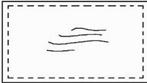
Figura 1.30 - Fissuração por esmagamento do concreto, devido à reduzida espessura da laje. As fissuras surgem na face superior, por deficiência diante dos momentos positivos.
