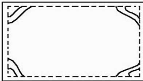
Figura 1.32 - Fissuração por deficiência de armaduras para combater os momentos volventes, na face superior da laje
