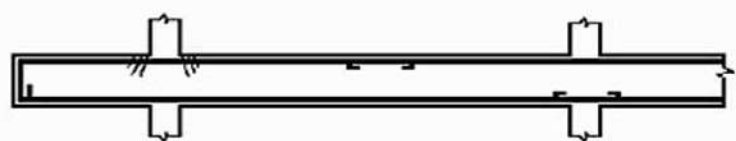
Figura 1.24 - Fissuração por flexão, como consequência da insuficiente seção de aço diante do momento negativo
