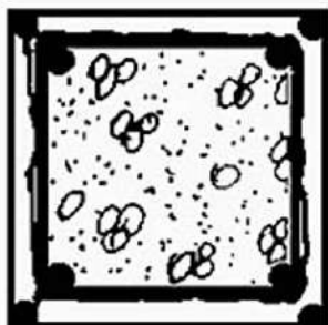
Figura 3.57- Colocação das novas armaduras no pilar
